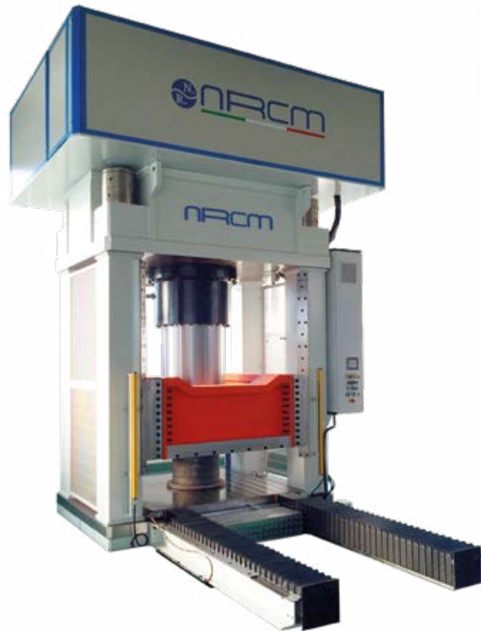
Pressa da 1000Ton per la produzione di compositi polimerici ( PTFE, PEEK )
