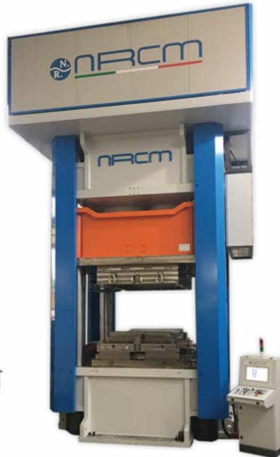
Pressa da 2000Ton per lo stampaggio di materiale composito "SMC / CARBON"
