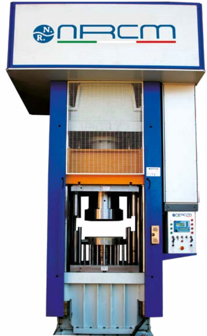
Pressa da 250Ton con premilamiera per imbutitura profonda. Stampaggio bombole.
